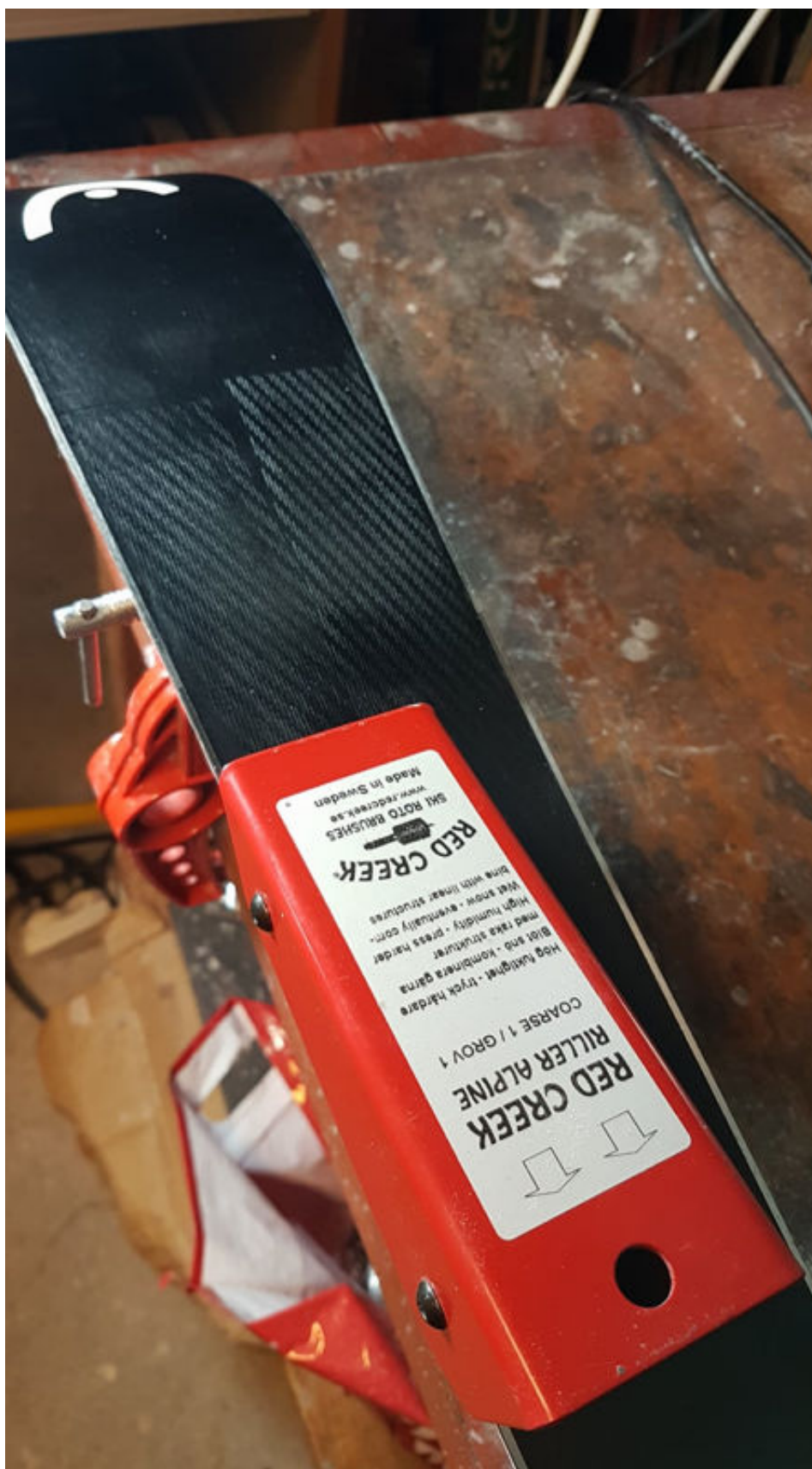
Alpine Riller +15/-5°C to strukturator mający za zadanie naniesienie struktury na ślizg narty zjazdowej w zakresie temperatur od +15°C do -5°C. Struktura ma za zadanie odprowadzić nadmiar wody ze ślizgu powstały podczas tarcia (gdy jest
